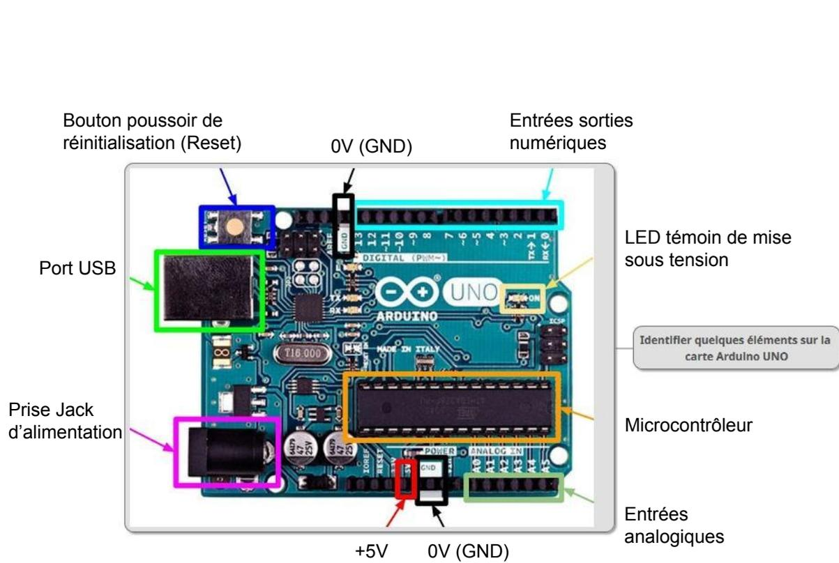
Identifier quelques éléments sur la carte Arduino UNO
